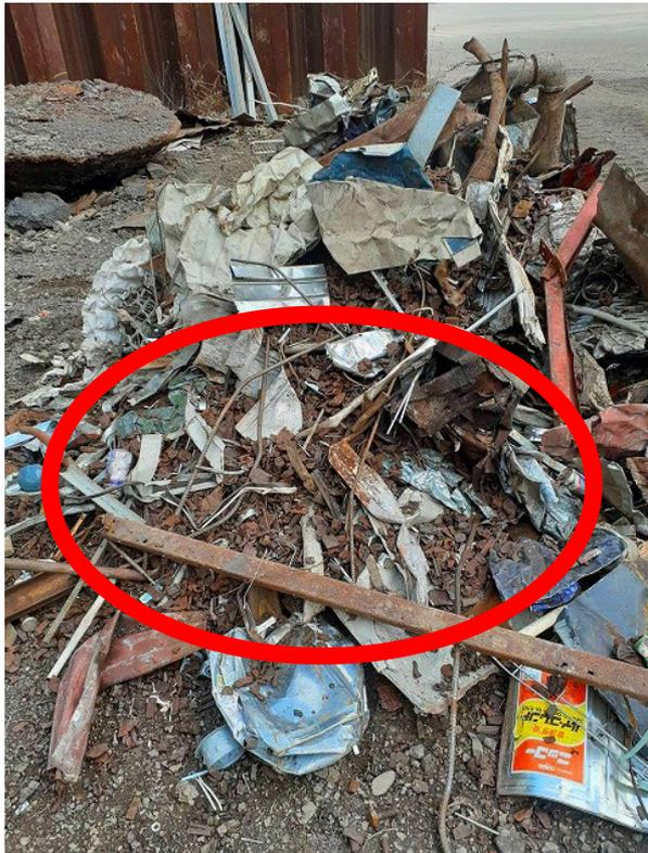
使用済の乾電池を業者にて処理・選別し、焼却後外装部の鉄部分のみの状態になっているのが特徴です。焼却処理された電池屑は、S(硫黄)分が高く、一定量以上のS(硫黄)分が溶鋼に溶け込んだ場合には、製品表面に肌荒れ異常が発生するため、**全量廃却**となります。
