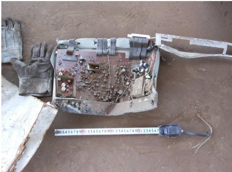
雑品スクラップとは、非鉄金属(銅・アルミ・ステンレス等)または非金属(樹脂・プラスチックなど)が付着した雑多な未解体、未選別のスクラップを指します。OA機器・配電盤・コンプレッサー・家電類などが該当します。
