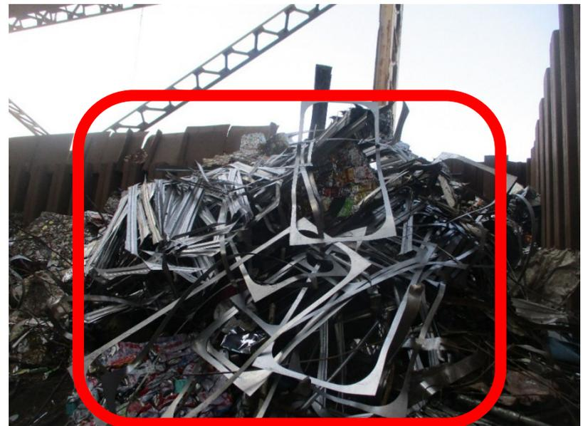
システムキッチンの外枠として使用されています。内枠はステンレスですが、外枠は材質が異なる為、内枠に溶接された状態でシステムキッチンとして納品されるのが一般的です。板厚自体は薄い為、防食性・耐錆性を高める為、他のスクラップと比較してもCr・Mo含有率が一段と多いのが特徴です。高Cr・Moとなった溶鋼は製品J I Sに規定された強度を越えるため、全量廃却となります。
