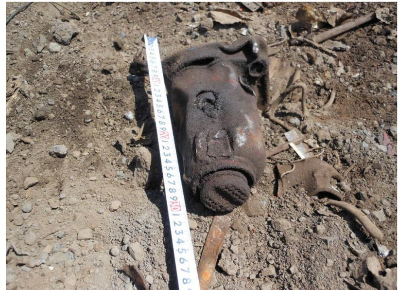
タンク類、油圧ジャッキ類等の密閉物は製鋼電気炉内で爆発の危険があります。
