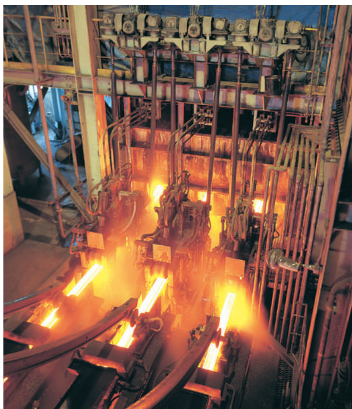
連続鋳造設備
